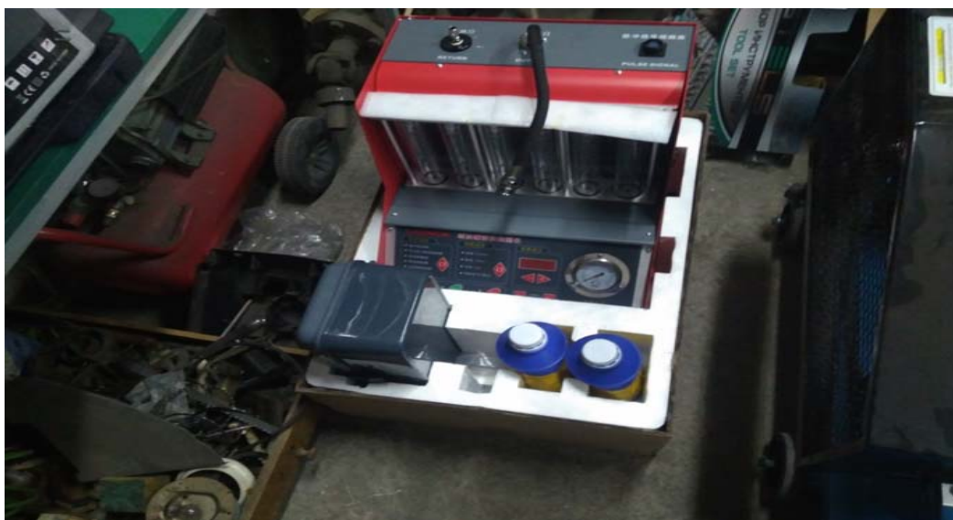
Фото 14. Стенд для проверки форсунок бензинового двигателя
