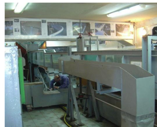
*Гидравлический лоток для исследования водосбросных и водоприемных элементов ГЭС*
