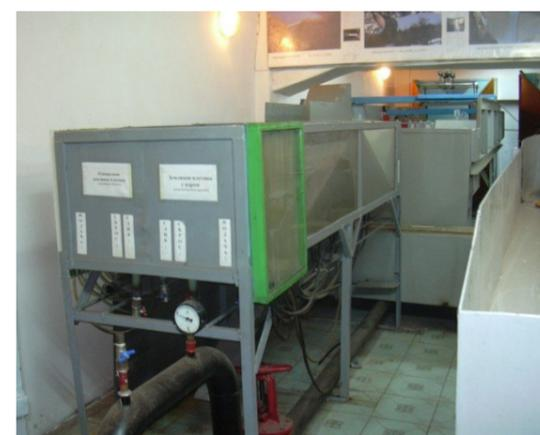
*Лабораторная установка для проведения исследований фильтрации воды через тело грунтовых плотин*
