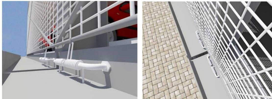
*Динамический гаситель колебаний в конструкции легкого сетчатого ограждения гаража-стоянки автомобилей*
