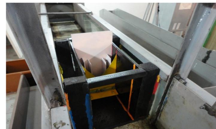
Физические исследования гидравлических характеристик стабилизатора расхода типа секционный параболический коробчатый затвор
