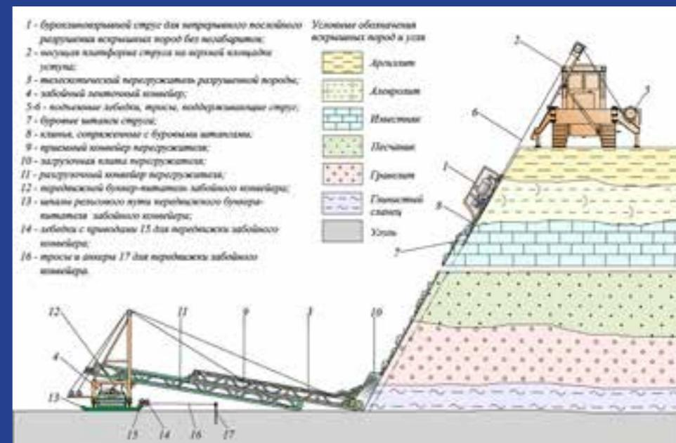
Технологическая схема поточной разработки скальных вскрышных пород непрерывными взрывами зарядов из воды
