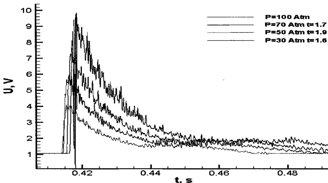
**Рис. 1.** Сигнал от датчиков импульсного давления в трубе на расстоянии двух калибров от среза клапана КБ-20-100-Р-УТ
