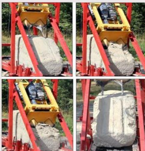
Процесс разрушения блока породы макетом буроклинового струга
