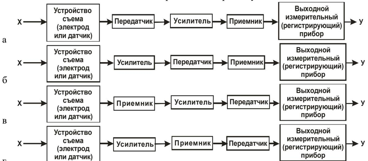
19. Схема работы шумомера:
