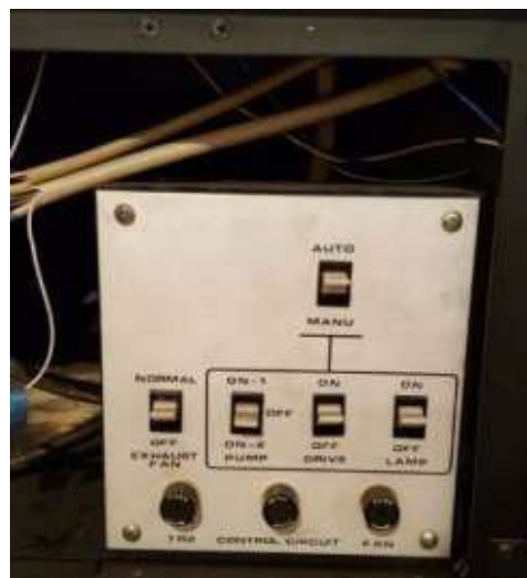
УФ-устройство для экспонирования изображения печатных плат на фоторезистор
