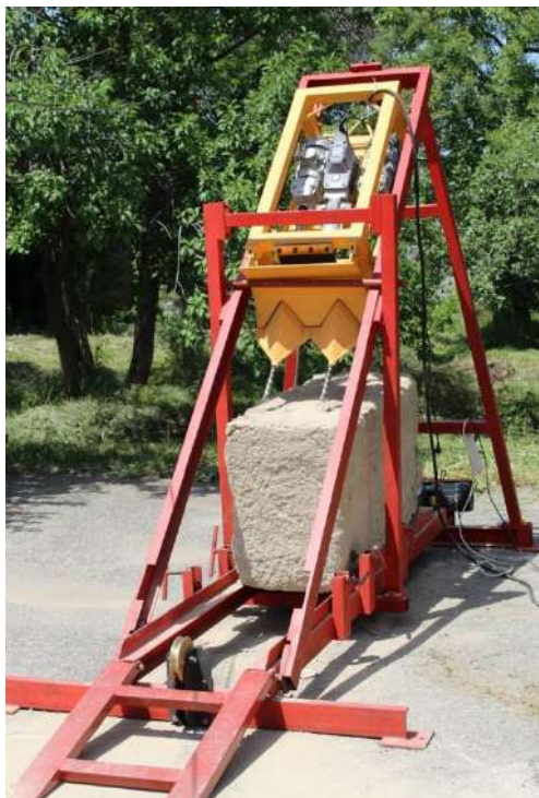
Действующий макет средней секции буроклинового струга
