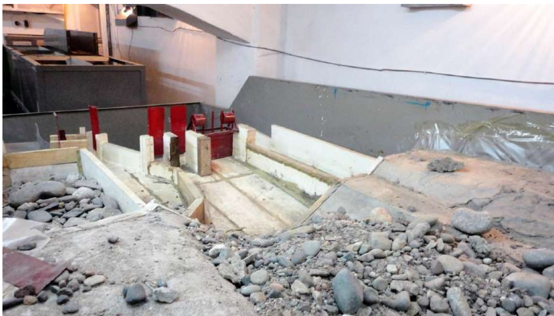
Физическая модель водозаборного сооружения на реке Иссык-Ата для подачи воды на МГЭС
