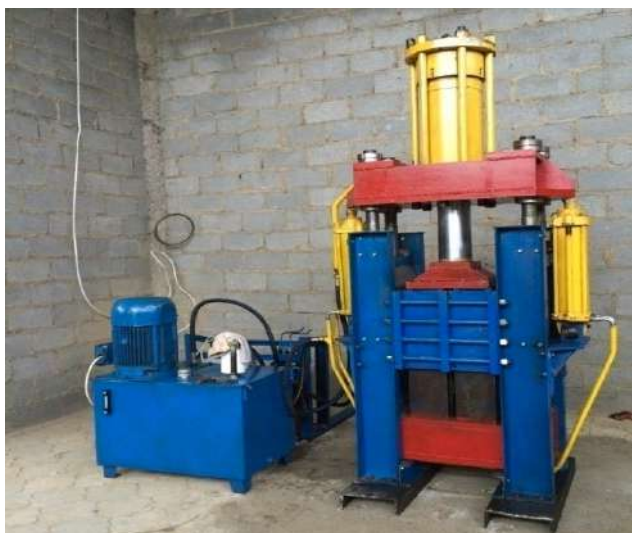
Действующий гидравлический пресс
