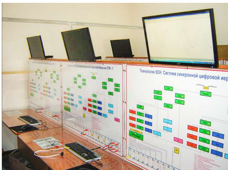
Лабораторный стенд «Технология SDH. Система синхронной цифровой иерархии STM-1»
