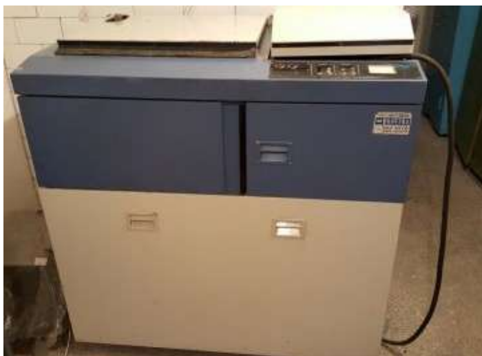
УФ-устройство для экспонирования изображения печатных плат на фоторезистор
