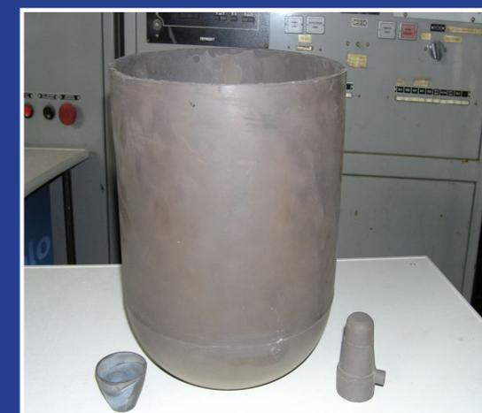
В микроэлектронике, где оправки из предлагаемого материала используются взамен графитовых, и в других сферах.
